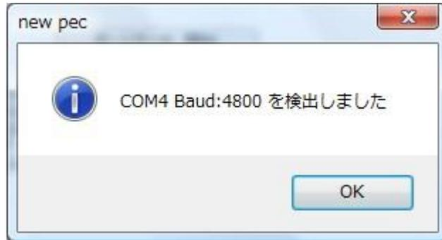
以下の[シリアルポート]～[ストップビット]までの設定項目は、[ポートサーチ]により自動的に設定されます。
