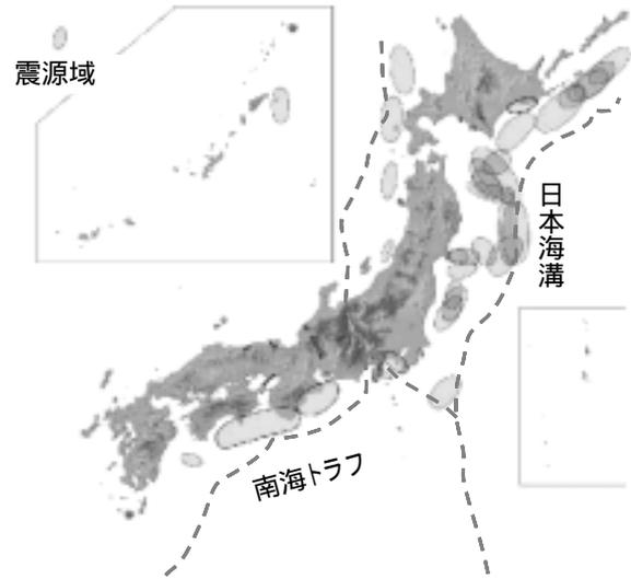
図 1 日本周辺の大地震の震源域（地震調査研究推進本部地震調査委員会作成の図に加筆）
