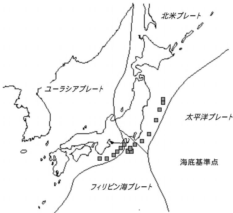
図4 海上保安庁の海底基準点
