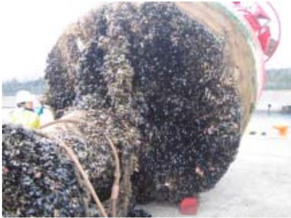
写真1：灯浮標の下面一面に付着したムラサキイガイ
