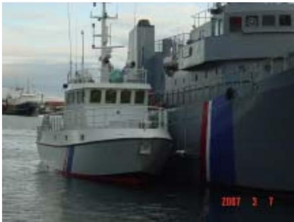
写真7 アイスランド水路部測量船 "Baldur", と大型警備船。レイキャビック港にて, 2007。 港湾測量や沿岸測量, 沿岸観測などをこの測量船でおこなう(長さ約20m, 幅5.2m, 喫水2.6m)。 沖合いや冬季の荒天時は必要があればコーストガードの大型船で海洋観測, 測量等を行う。
