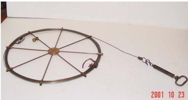
写真1 海洋情報部に残されている基線尺。英国製であるが製造年・購入年は不明。
