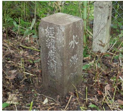
写真6 秋田にある大正7年設置の水路部天測標
