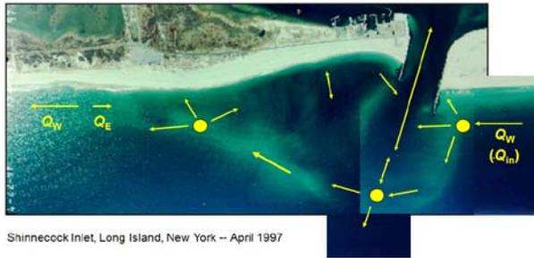
写真6 インレットの例（（故）クラウス博士が作成したニューヨーク州シノコックインレット周辺の土砂移動推定図）
