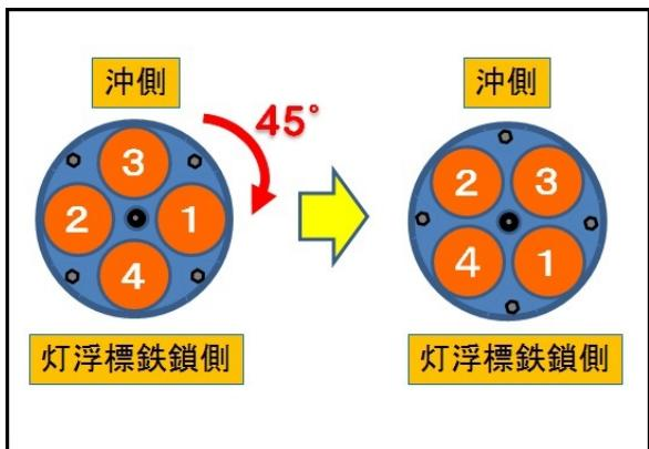
図 7 流速計を  $45^{\circ}$  回転
