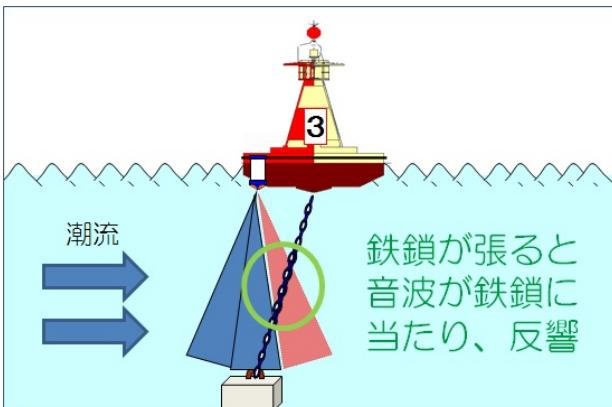
図 6 鉄鎖による流速計音波の反響
