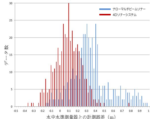
図5 水中水準測量器との計測差の頻度分布
