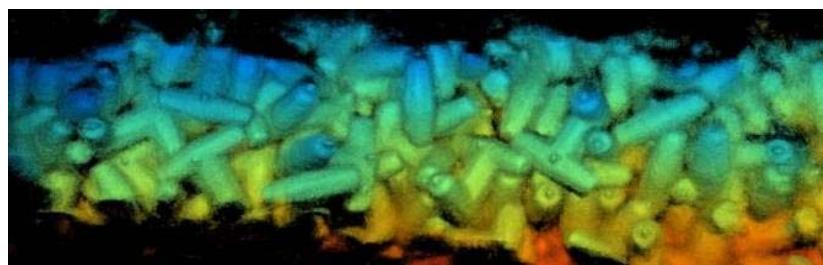
図2 消波ブロックの計測
