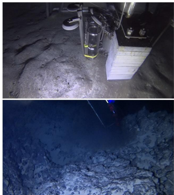
図3 深海カメラによって撮影された映像のスナップショット（上：マルチプルコアラー、下：岩石ドレッジ撮影時）
