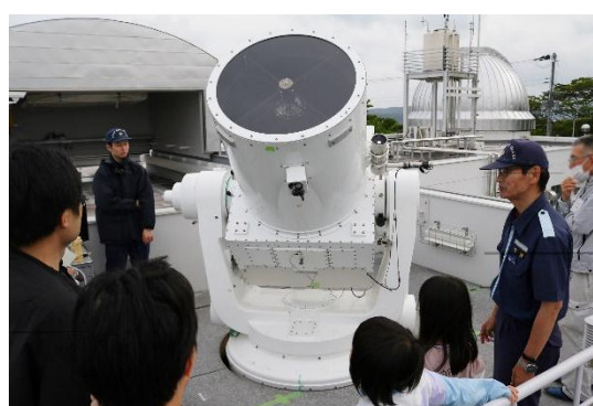
口径75cmのレーザー観測用望遠鏡
