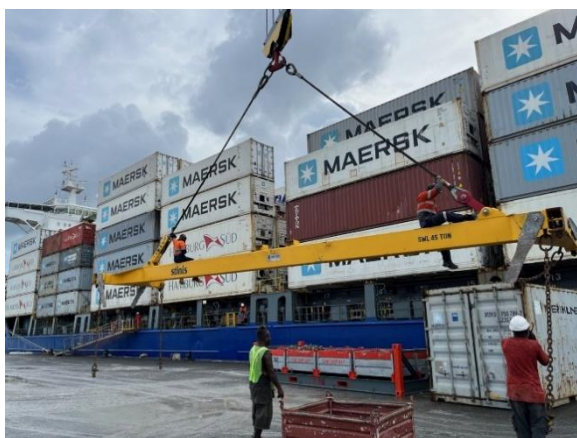
ノロ港の作業員。安全帯なしでクレーンに吊られて作業している。
